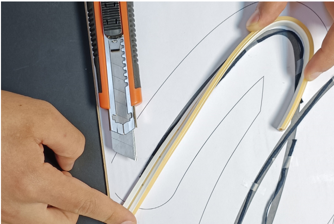
Fig.8 Tenint en compte la maqueta inicial a tamany real que hem fet, anar tallant el cable que utilitzarem per anar empalmant les tires LED.
