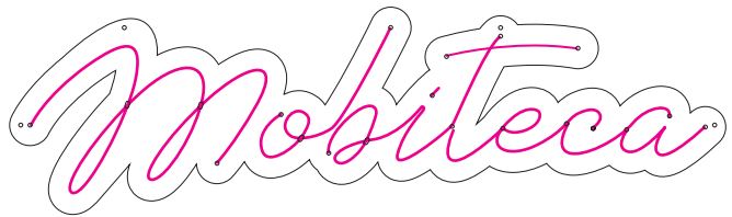
Fig.3 Vista de detall de la planificació dels traços i dels forats.
