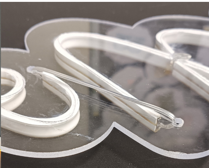
Fig.11 Fer passar el cable pel darrera fent servir els orificis planificats.
