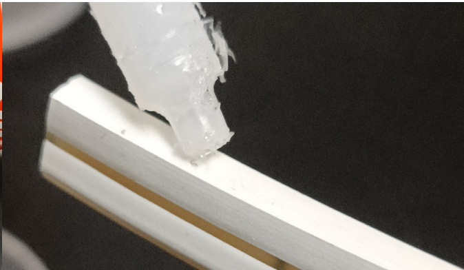
Fig.14 Amb cura dosificar la pega a la tira LED, aguantar els segons necessaris fins que veiem que ja s'ha enganxat.
